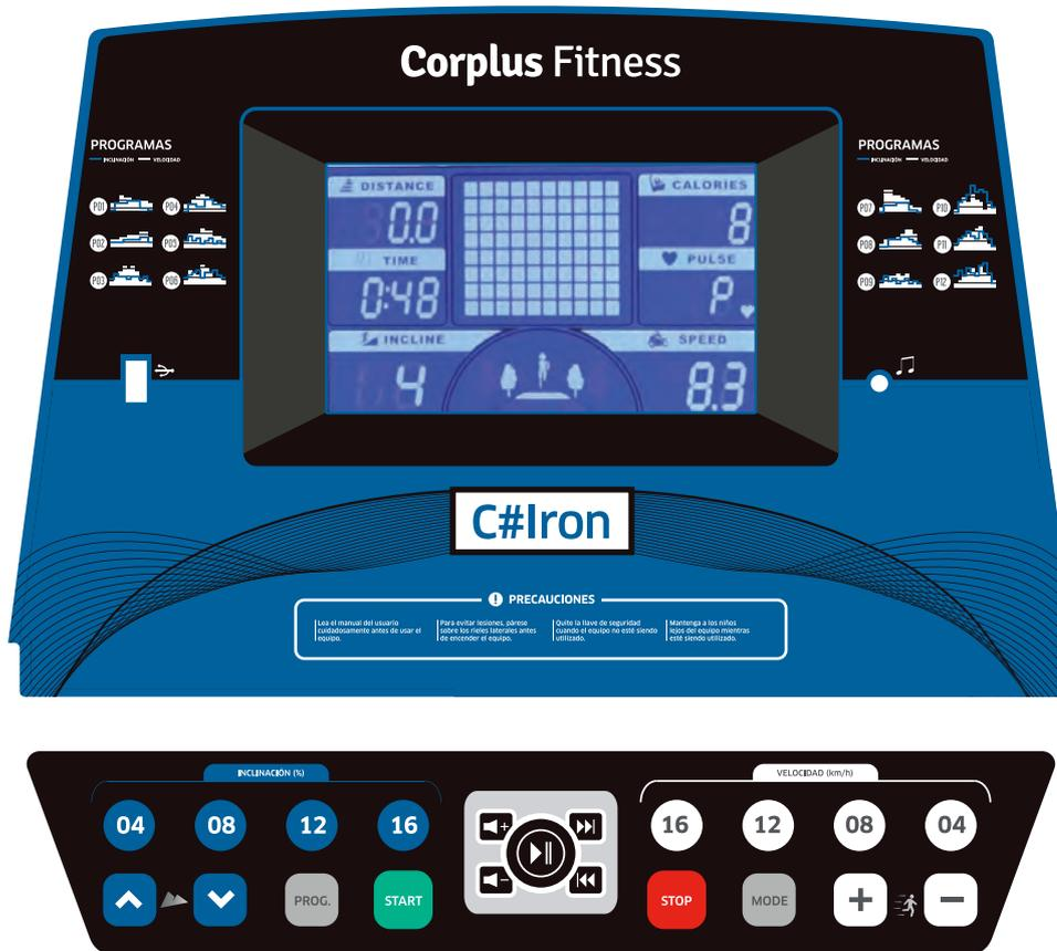
**TECLAS DE FUNCIONES:** START (Comenzar), STOP (Detener), PROGRAM (Programa), MODE (Modo), SPEED (Velocidad) +/- (atajo rápido), INCLINE (Inclinación) +/- (atajo rápido), VOLUME (Volumen) +/-.
