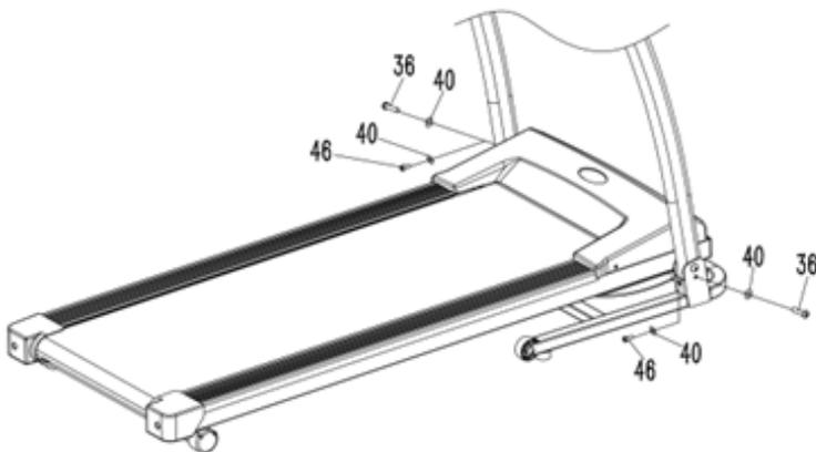
Eleve el tubo vertical izquierdo y el tubo vertical derecho como se muestra en el dibujo de la izquierda.
