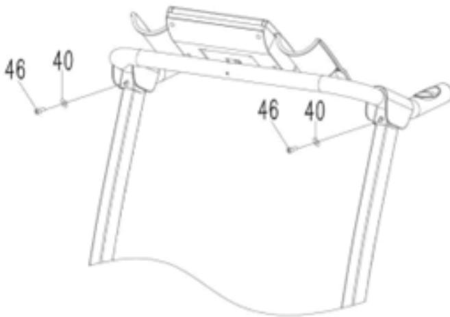
Utilice los tornillos (46) y arandelas (40) para fijar la consola a los tubos verticales izquierdo y derecho.
